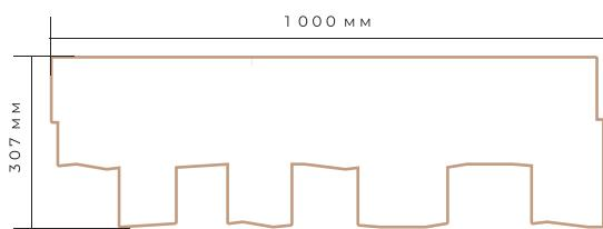
Более высокий коэффициент перекрытия, за счет которого черепица обладает улучшенной гидроизоляцией
